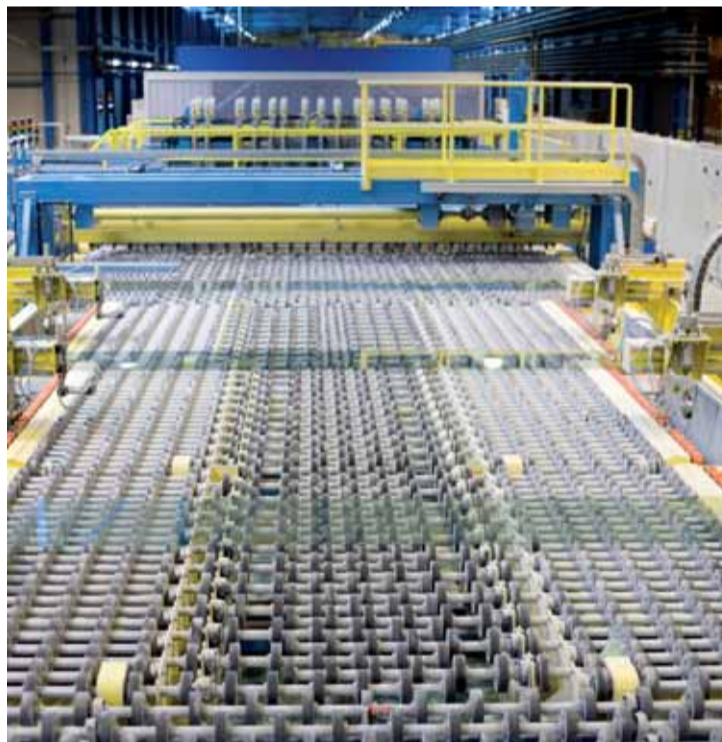
Nová linka v současnosti vyrábí dva druhy zeleného skla v tloušťkách od 1,6 mm do 6 mm. Z celkové produkce R3, která činí 255 500 tun utavené skloviny, se ročně vyrobí 180 000 tun skla. Necelá třetina skloviny se vrací zpět do výroby jako surovina pro přípravu sklářské vsázky.
