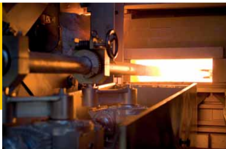
Nejvíce horké místo v provozu - tavicí agregát ve vaně: 1590 °C.
