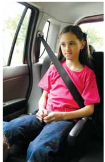
Pás dítěti v autosedačce nesmí vést přes krk (při nárazu by se mohlo uškrtit), ale vždy přes klíční kost.
