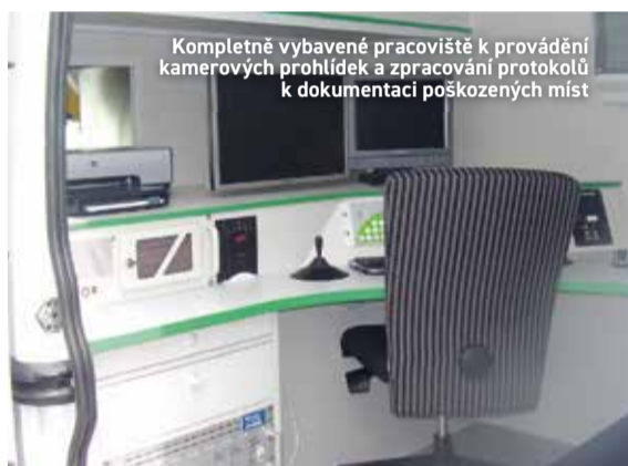
Kamerový vůz Renault Master s vestavbou Rausch
