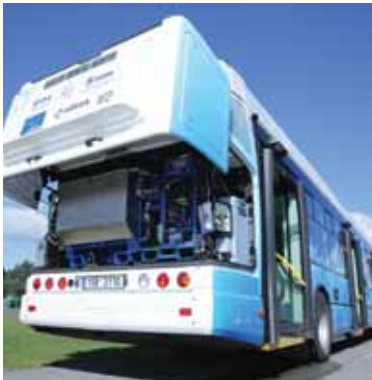
Celkový pohled na hlavní části vodíkového pohonu autobusu pro městskou hromadnou dopravu
