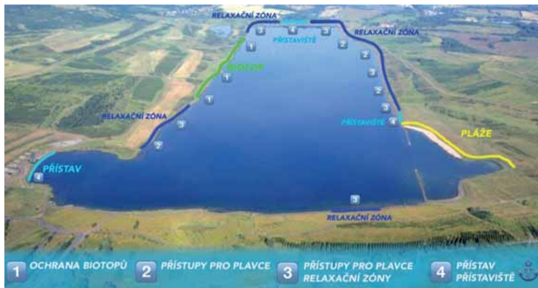
Milada je rekultivační jezero vytvořené v těžební jámě hnědouhelného dolu Chabařovice, v místě bývalých obcí Hrbovice, Tuchomyšl a Vyklice. Má rozlohu 252,2 ha, průměrnou hloubku 15,5 m a maximální hloubku 24,7 m. Objem vody činí 35 601 000 m 3 . Jezero Milada je první velkou vodohospodářskou rekultivací v Česku. Jako takové se stalo vzorem i pro další obdobné projekty v severozápadních Čechách, v Ústeckém a Karlovarském kraji, kde byla krajina silně narušena povrchovou těžbou uhlí.
