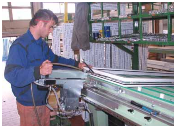
Na snímku Michal Štefko právě montuje kování na plastové okno.
