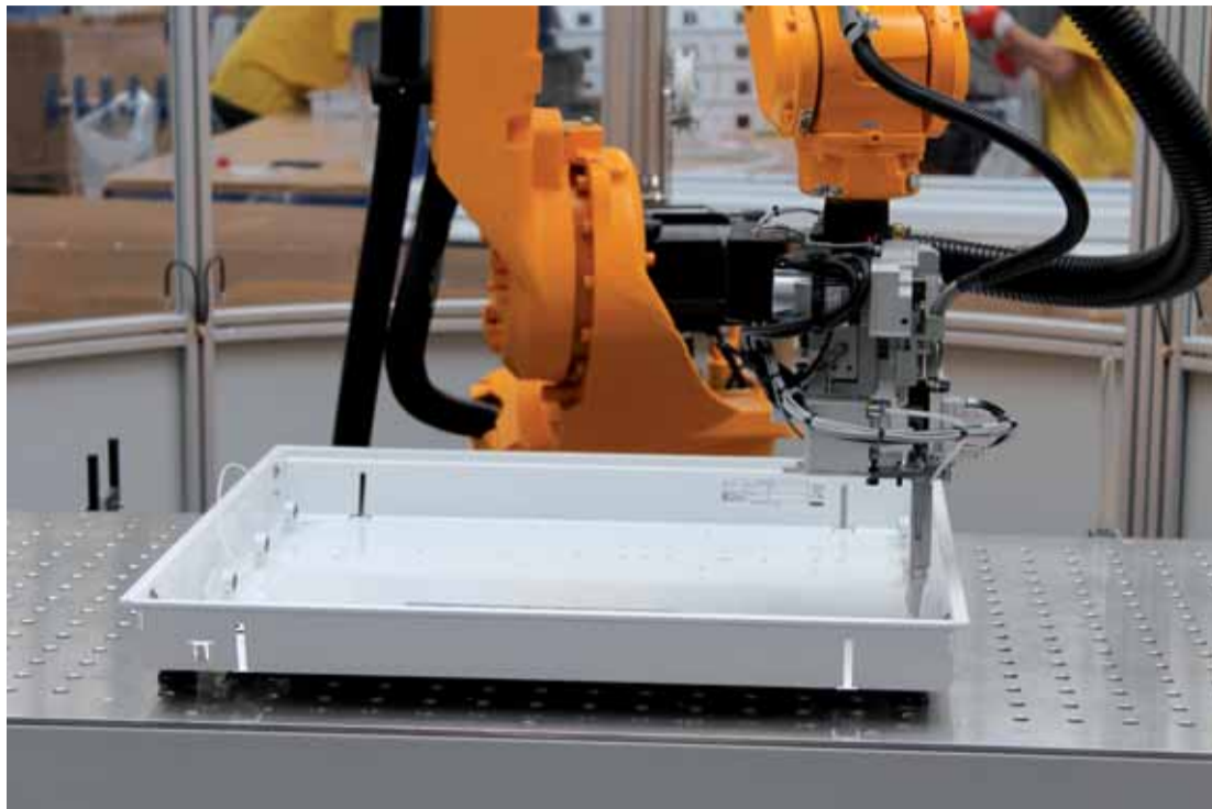
Drátovací robot ve zkušebním provozu.
