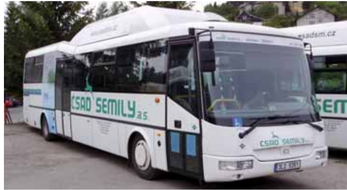
Autobus SOR 12,0 na CNG, rok výroby 2008, emisní třída EURO 5.
