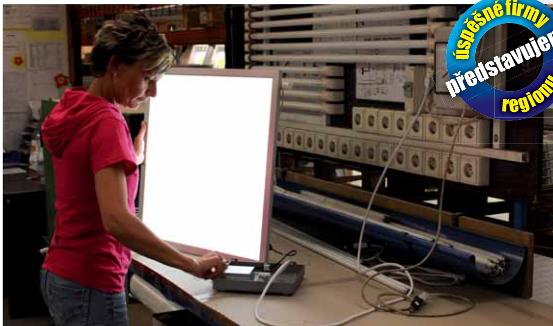
Zkoušení svítidel s inovovanou LED technologií.
