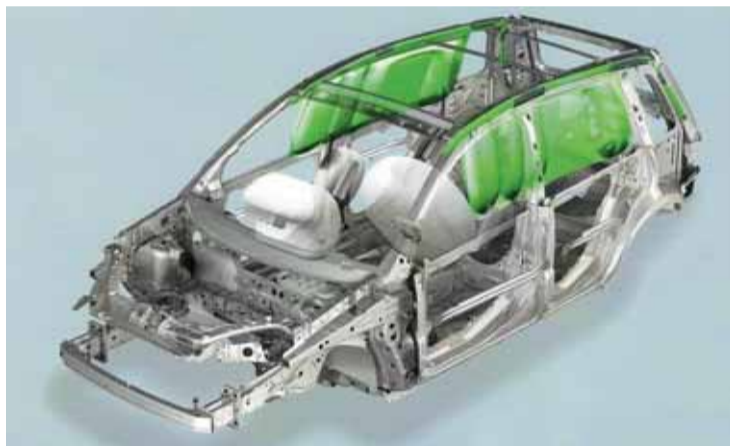
Ford Fusion má kromě předních (standardní výbava) a bočních airbagů (výbava na přání) také stropní airbagy (výbava na přání).
