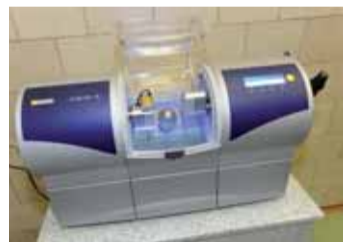
Frézovací přístroj během pár minut vytvoří z keramiky zubní náhradu.
